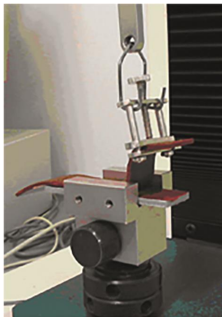
5-rasm - Tekis jag‘li qisqich tizimi bilan sinov uchun sinov namunasi va qisqichlarni joylashtirish
